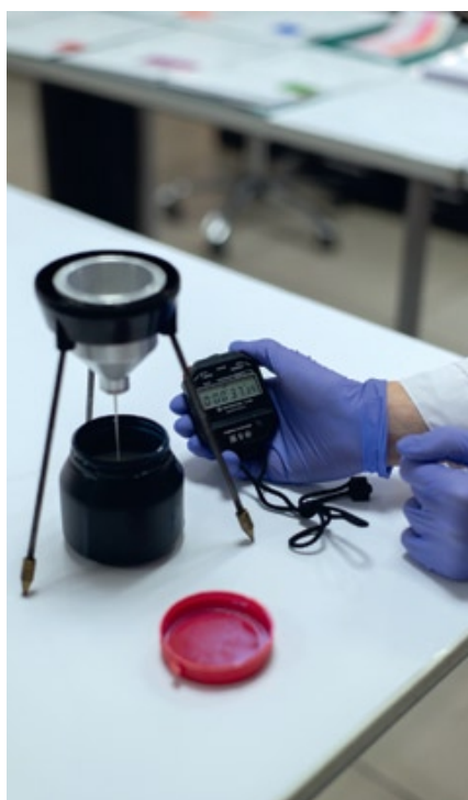
Измерение вязкости лака
