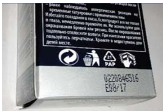
Рис. 4. Пример нанесения чернил по лаку. Вместо лака Графилак 732 предложено использовать лак Графилак UV 579 GS BF
