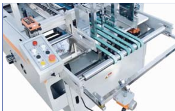
Рис. 3. Вверху: Фрикционный механизм подачи заготовок фальцевально-склеивающей линии. Внизу испытание лака скорректированного лака
